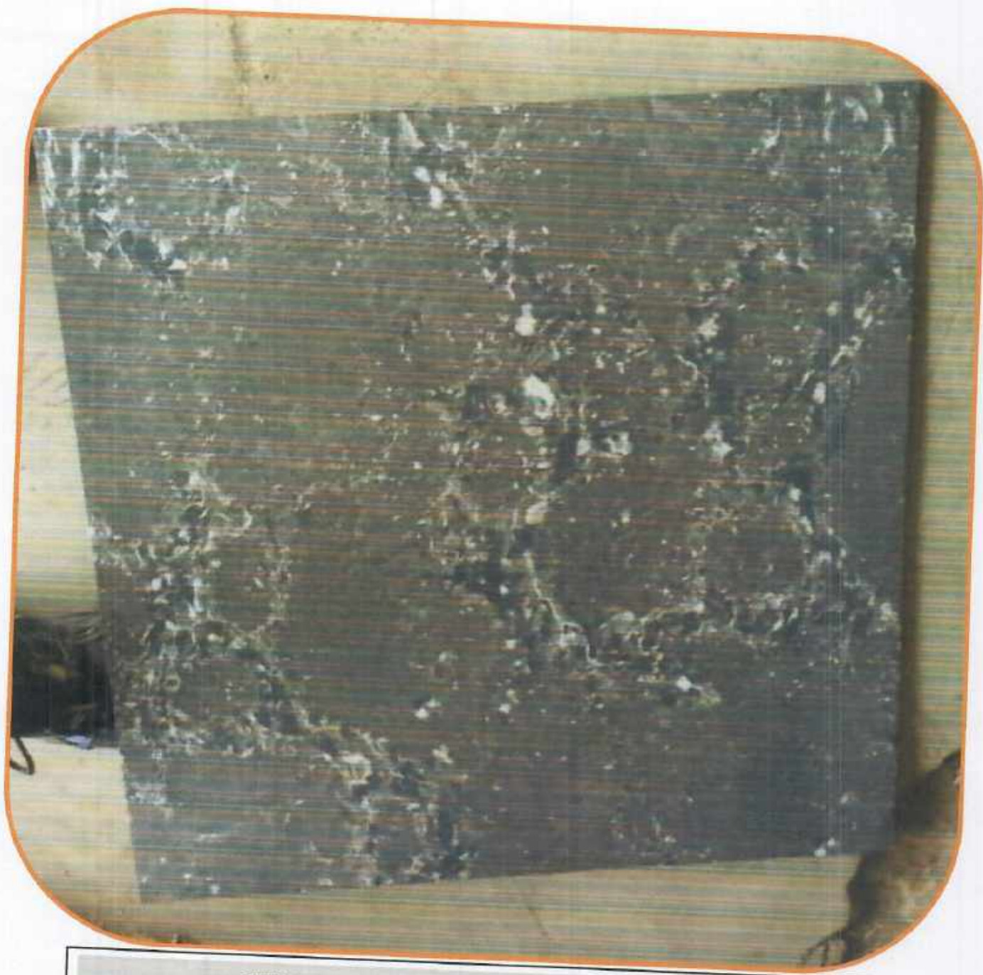
Carreaux sol vitrifié pour les amphithéâtres (Dimensions : 60x60cm) A poser dans les salles d'amphithéâtre ainsi la terrasse
